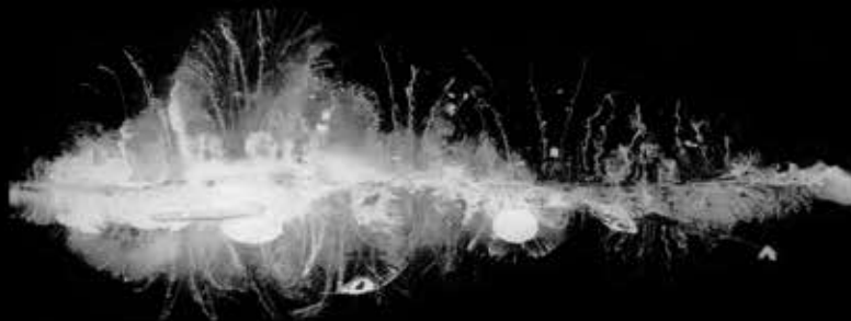
Simulierte Wundhöhle in Gelatineblock / Geschosswirkung in Gelatine
