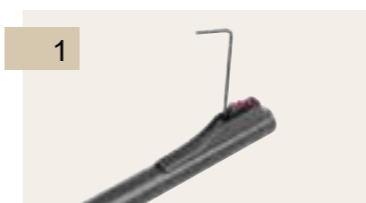
1 La hausse et le guidon sont fixés au canon par une vis cachée.
