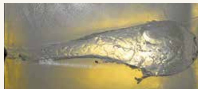
Simulation de l'effet d'impact d'une SPEED TIP PRO Calibre .300Win. Mag. À 350m
